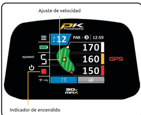
Configuración de velocidad: Gire el botón central para ajustar la velocidad del carro de 0 a 9 cuando el motor está encendido. Presione el botón central para pausar y reanudar la velocidad seleccionada.
