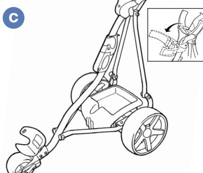
**5** Una volta caricata la batteria, collegarla come mostrato in figura. L'attacco della batteria acido piombo è spostato, pertanto assicurarsi di connettere la batteria in modo corretto.
