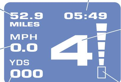
**Yards/Meter** – zeigt die Gesamtentfernung an, die für den aktuellen Schlag zurückgelegt worden ist. Diese kann auf Null zurückgesetzt werden, indem man die **↑ + ↓** Pfeile gedrückt hält.
